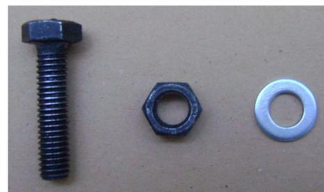
Fig. 4. Oil-hardened steel bolt.
